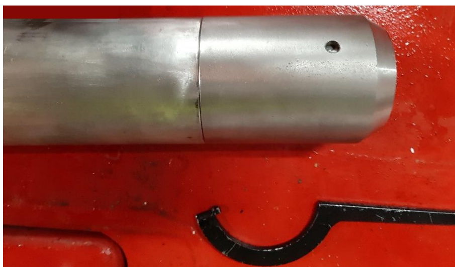
Ryc.4.6.3. Montaż stopki tnącej, (fot. archiwum ZGM)
