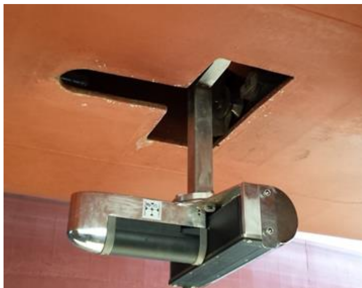
Ryc. 3.42. Przetwornik echosondy wielowiązkowej SeaBat 7125 przytwierdzony do metalowego uchwyty, chowany za pomocą hydraulicznego podnośnika wewnątrz kadłuba statku r/v Oceanograf , ( http://arch.ocean.ug.edu.pl/pages/wersja-polska/archiwum/galeria-budowy-statku/oceanograf.php )
