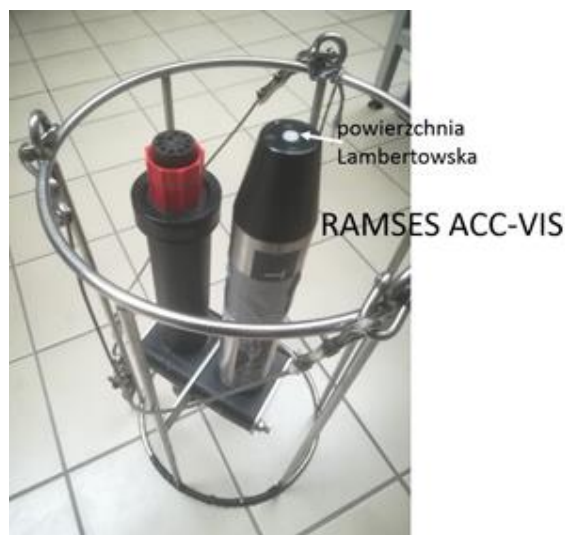
Ryc. 3.26. Miernik oświetlenia RAMSES ACC-VIS ustawiony do pomiaru oświetlenia odgórnego, (fot. M. Misiewicz)
