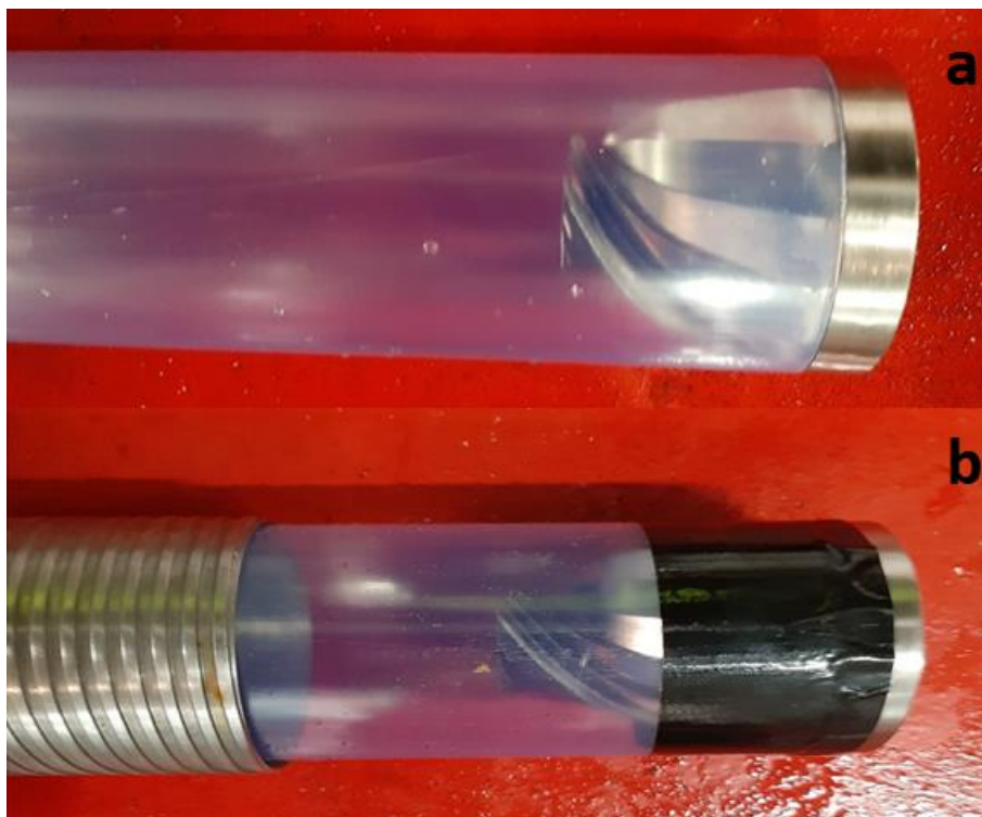
Ryc.4.6.2. Montaż chwytacza rdzenia w gilzie, (fot. archiwum ZGM)
