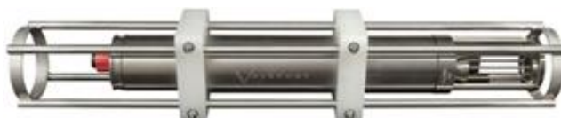
Ryc. 3.45. Miernik prędkości dźwięku w kolumnie wody miniSVP (Valeport), (mini SVP, 2013)
