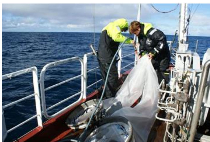
Ryc. 3.17. Sieć planktonowa typu Bongo w trakcie płukania, (fot. A. Panasiuk)
