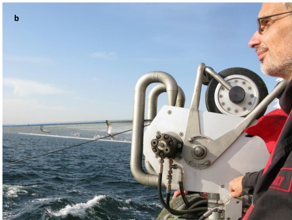
Ryc. 3.4. Zautomatyzowana obsługa sektorowych sieci skrzelowych: a) wydawanie; b) wybieranie, (fot. A. Lizińska)
