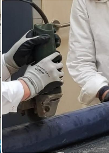
Ryc. 4.6.7. Rozcinanie gilzy z osadem, (fot. archiwum ZGM)
