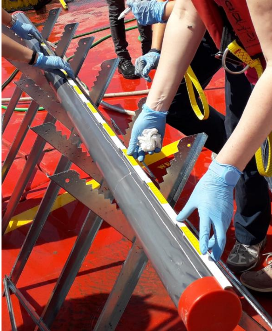
Ryc. 4.6.5. Pomiar, opis gilzy z pobranym rdzeniem, (fot. archiwum ZGM)
